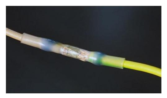
8. После монтажа необходимо обеспечить неподвижность соединения, пока не затвердеет припой. Это легко определить по замутнению в корпусе гильзы ПК-Т (КВТ).
