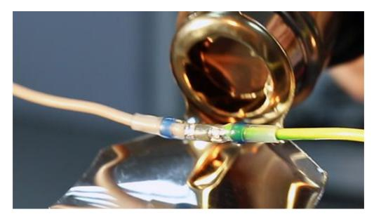
7. После этого равномерно нагревайте припой до тех пор, пока он полностью не проникнет внутрь соединения.
